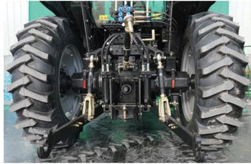
Трактор RAGNAR R160 оснащен трехточечным навесным устройством III категории, соответствующим международным стандартам. Усиленные подъемные рычаги трехточечной навески совместимы с широким спектром навесного оборудования.
