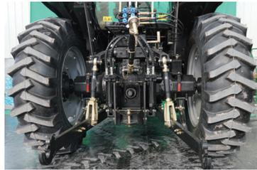
El enganche de tres puntos de Categoría III cumple con la norma internacional. El soporte de conexión superior de una pieza integra la carcasa del chasis y la carcasa del elevador hidráulico, lo que aumenta la resistencia para evitar el daño de la carcasa en operaciones de carga pesada.
