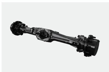
Los tractores 4W D R160 de RAGNAR funcionan con un eje delantero mejorado que es lo suficientemente fuerte como para trabajar con el motor de potencia de hasta 210 caballos de fuerza, y el cilindro hidráulico montado en el centro con doble acción suministra una excelente capacidad de carga y una distribución uniforme de la carga a la izquierda y a la derecha. Con un ángulo de giro mayor y un radio de giro pequeño, el tractor puede girar con flexibilidad.
