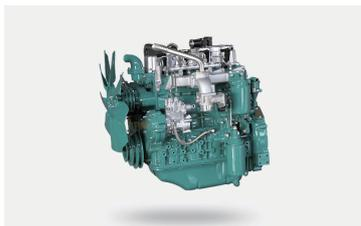
Los tractores de la serie RAGNAR R70 están equipados con un motor diesel de riel común de cuatro cilindros con inyección directa y multipunto de combustible, lo que permite una combustión más completa y un menor consumo de combustible. Son de 70 HP, y tienen un gran par de salida de 265 N•m, lo que ayuda a realizar el trabajo de forma rápida y sin problemas.
